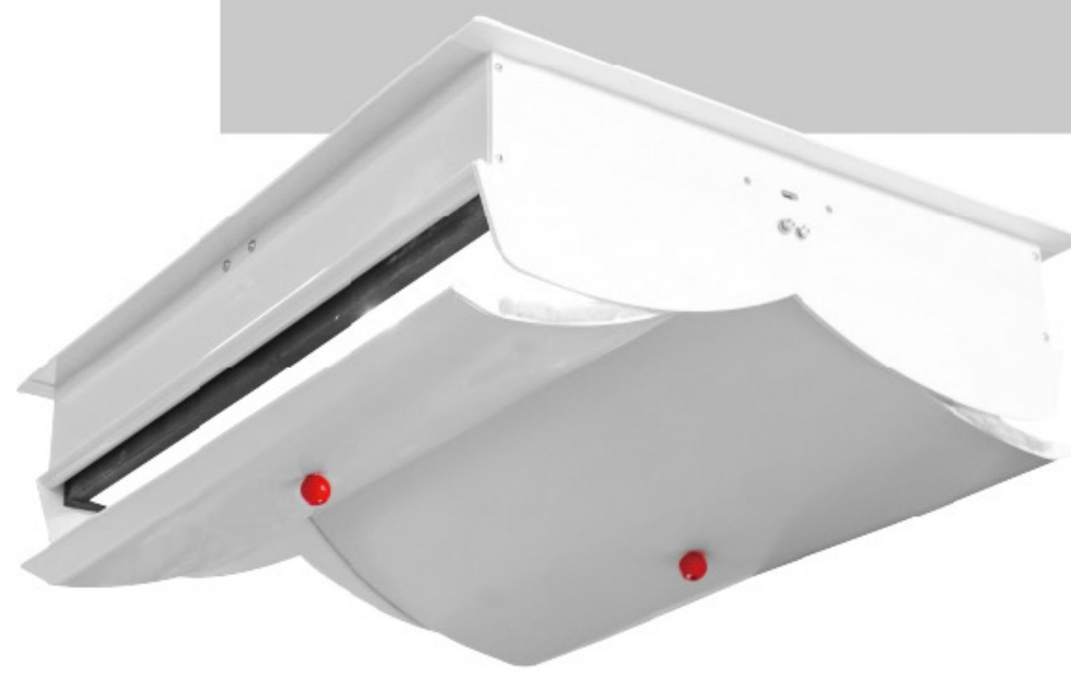
吊顶进风窗安装于猪舍吊顶，电机控制。可用于全年通风，可连接环境控制器，根据舍内环境，自动控制开口大小及方向。
